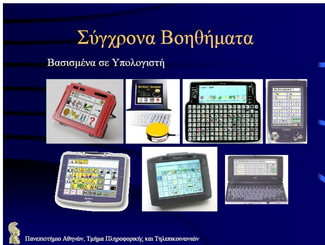
Σχήμα 2: Τα σύγχρονα βοηθήματα βασισμένα σε Η/Υ αποτελούνται από ειδικά σχεδιασμένα πληκτρολόγια που συνδέονται σε κονσόλες, από palmtops και pda's
