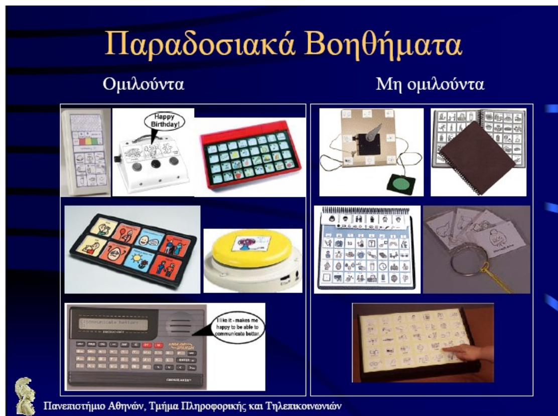
Σχήμα 1: Τα παραδοσιακά βοηθήματα αποτελούνται από ηλεκτρονικές συσκευές πληροφορολογίων, ατζέντες και κάρτες που είναι είτε ομιλούντες είτε όχι.
